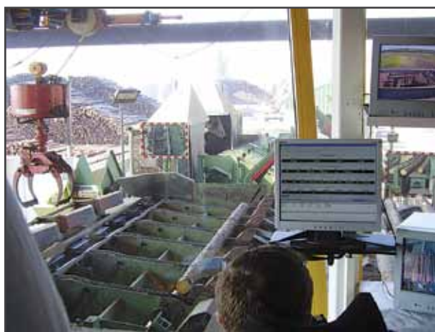
Obr. č. 19: Elektronické měření dříví na pile
